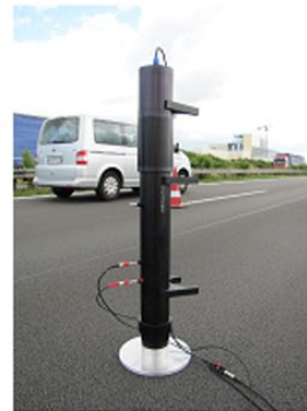
阻抗管聲波傳遞模擬及阻抗管量測道路吸音係數
